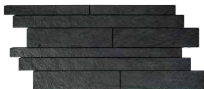
IND 60 Cenere Altezza / Heights 3,3 / 4,4 / 6,7 cm. Lunghezza / Length 30 / 60 cm. Spessore / Thickness 1 cm. Optional: su rete con fuga da 2/3 mm. Optional: on mesh with joint of 2/3 mm.
